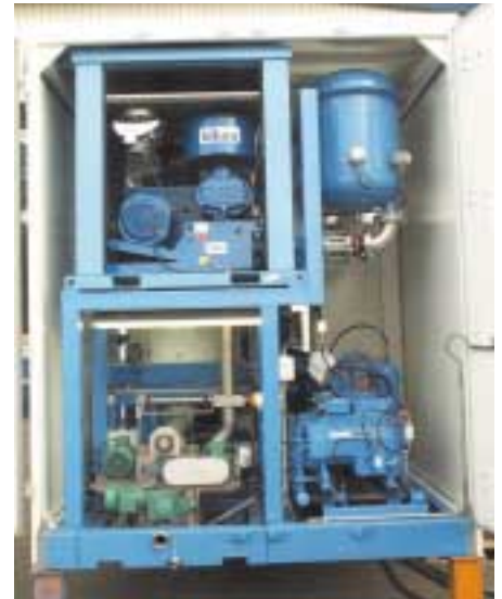
Zerkleinerungs- + Gebläseeinheit einer Allwetter-Kanone
