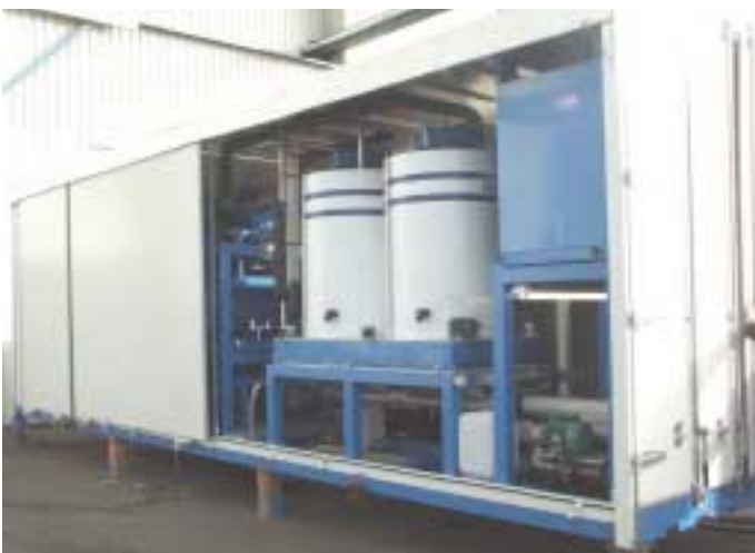
Eine Allwetter-Kanone in einem Container
