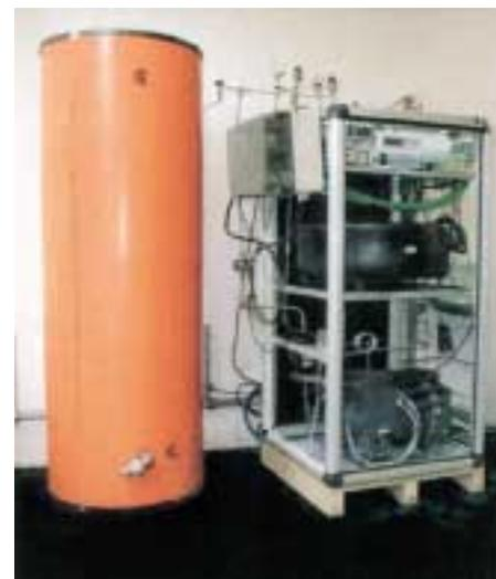
Inneneinheit der CO<sub>2</sub>-Wärmepumpe mit Pufferspeicher im Feldversuch
