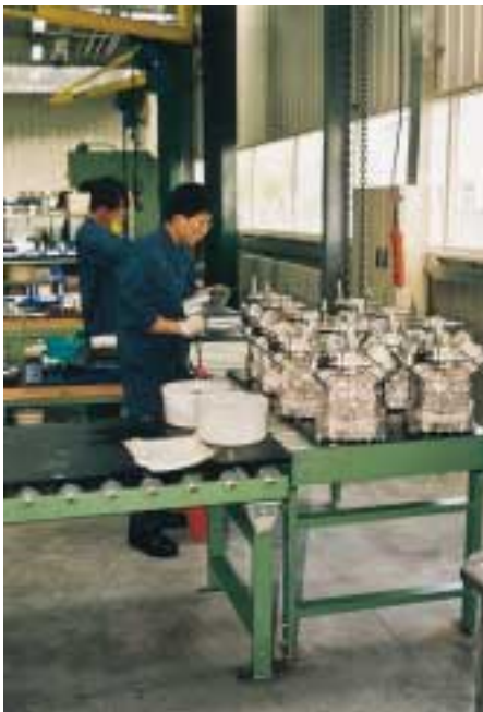
Montage Aluminium-Verdichter mit Druck- und Leckagetest, Öl einfüllen und Trocknen sowie Performancetest
