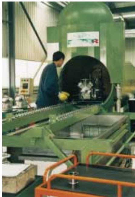
Montage Aluminium-Verdichter mit Druck- und Leckagetest, Öl einfüllen und Trocknen sowie Performancetest
