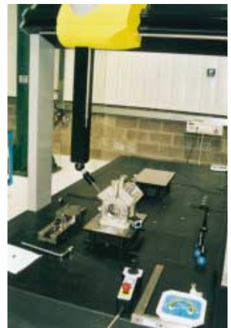
Qualitätssicherung. Ein Lagerdeckel und ein Verdichtergehäuse unter der 3 Koordinaten-Meßmaschine
