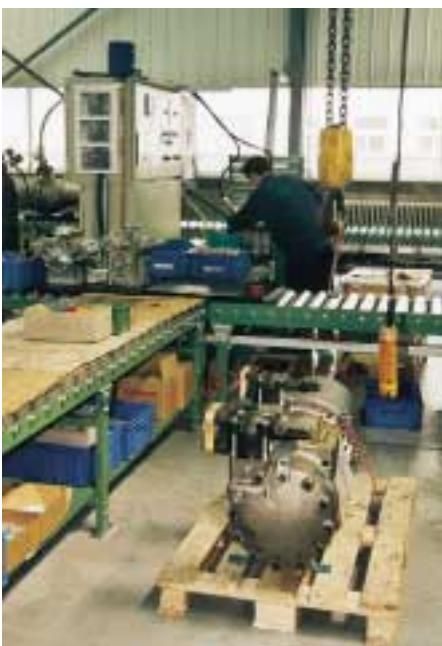
Schraubenverdichter werden gegenwärtig in China noch für das Kältemittel R 22 ausgelegt, inzwischen sind aber schon R 134a-Schrauben mit größerem Fördervolumen (bei gleicher Antriebsleistung) verfügbar, deren COP auf einem höheren Level wie R 22 liegen
