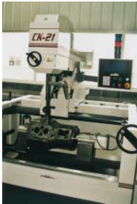
BCB, eine 100%-Tochtergesellschaft der Bitzer Kühlmaschinenbau Holding in Sindelfingen, wird von Thomas Bolz als Managing Director geleitet. Hier an einem vertikalen Bearbeitungszentrum, wo gerade Verdichterabschlußdeckel gefertigt werden. Daneben Honnen eines Sechszylindergehäuses für Schraubenverdichter
