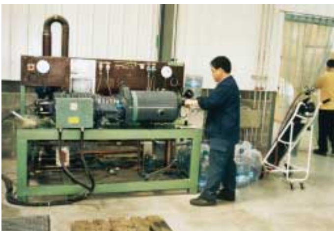
Service ist sehr wichtig. Hier ein separater Teststand für reparierte Schraubenverdichter
