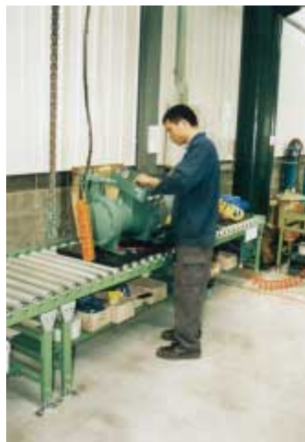
Schraubenverdichter werden gegenwärtig in China noch für das Kältemittel R 22 ausgelegt, inzwischen sind aber schon R 134a-Schrauben mit größerem Fördervolumen (bei gleicher Antriebsleistung) verfügbar, deren COP auf einem höheren Level wie R 22 liegen
