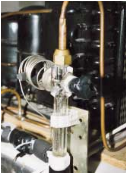
Für Unterrichtszwecke wohl ein Unikat: Sichtbarmachung des Drosselvorgangs mit Drosseldampfbildung in einem Expansionsventil aus Plexiglas (gestiftet von Egelhof)
