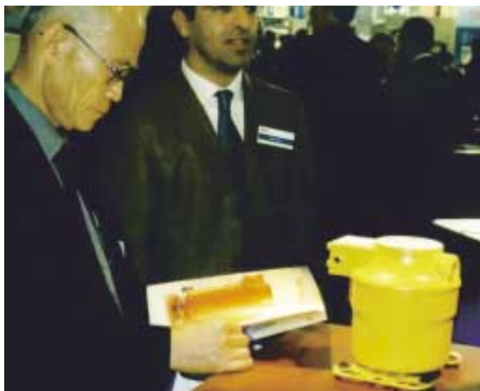
Halbhermetikverdichter von Bock für das Kältemittel CO 2
