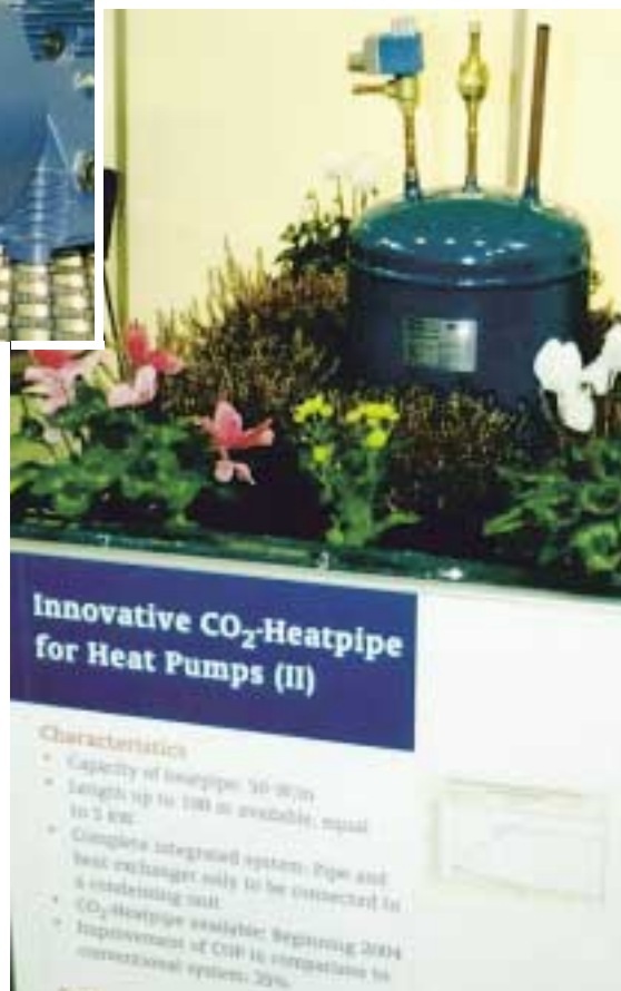
Kopf der CO 2 -Wärmepumpensonde des FKW Hannover
