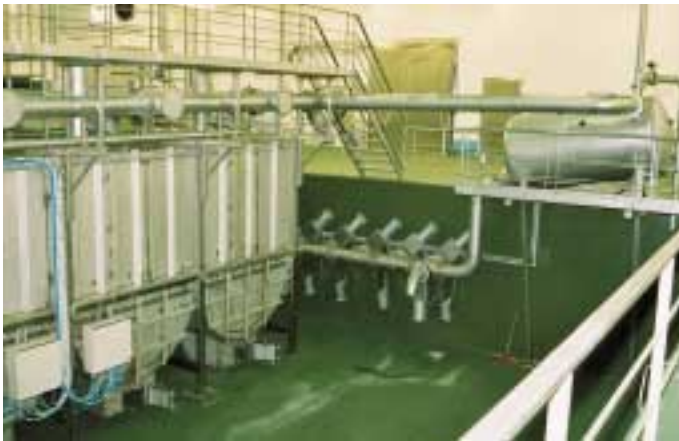
Kleinere Fangschiffe mit Ostseeheringen werden über diesen Seewasserbehälter entladen und die Fische von dort direkt durch Pumpen in durch CO 2 auf +2 °C gekühlte Fischtanks zur weiteren Behandlung angesaugt
