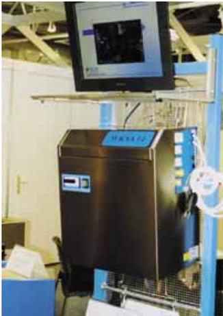
Bei **ROCHHAUSEN KÄLTESYSTEME** gab es u. a. einen wassergekühlten kompakten Splitkältesatz mit vorgefertigter und gefüllter Leitung z. B. für Kühlzellenverdampfer aus einer Baureihe von 1,6 bis 4,2 kW bei  $-5^{\circ}\text{C}$  und mit R 134a zu sehen. Solcherart sind auch die anderen Produkte des vielfältigen Firmenprogrammes. Alles wird in kleinen Serien kundenspezifisch gefertigt
