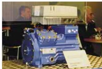
Bei **Bock** stand der neue PLUS-COM-Halbhermetikverdichter im Mittelpunkt des Messestandes. Er folgt dem Trend zu kompakter Bauweise und bietet damit anwendungstechnische Vorteile. Eine elektronische Leistungsregulierung mittels Frequenzumformer von 20 bis 70 Hz und das eingeschlossene Softstartsystem macht diese Verdichter vor allem für Anwendungen mit wechselnden Lasten attraktiv
