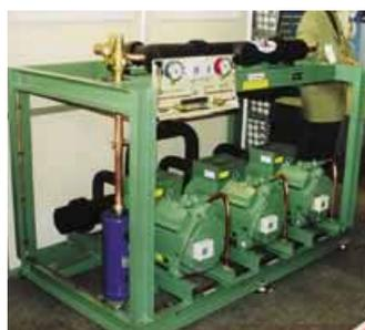
Verdichtersätze der Dresdner Firma **compact** sind fest am Markt etabliert. Immer wieder werden spezielle Ausführungen genau dem Kundenwunsch entsprechend gefertigt. Ausgestellt war u. a. ein Dreiverdichterverbund mit Ölausgleichsrichtung und Sauggassammler. Die Palette der möglichen Lösungen reicht über Zweistufigkeit, Mehretagigkeit, NK-TK-Verbunde bis zu Umhausungen
