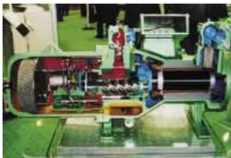
Das Schraubenverdichterschnittmodell am **Bitzer**-Stand war immer umlagert. Bitzer hat die Kompaktschrauben CSH mit der dualen Leistungsregelung bis auf 900 m<sup>3</sup>/h erweitert und bietet sie nun auch für R 134a an. Daneben gab es auch die jetzt lieferbaren EURO-Scroll-Verdichter ESH7 zu sehen, die durch die spezielle Sauggaskühlung eine hohe Leistungszahl im Klimaeinsatz erreichen
