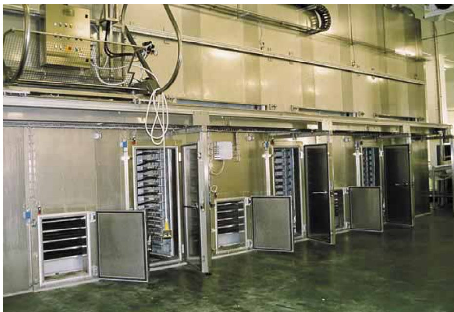
Alles vollautomatisch. 4-teiliger Plattenfroster mit einer Frostkapazität von 240t/Tag; danach vollautomatisches Abpacken und Palettieren
