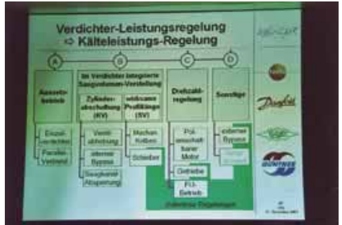
Vortrag Höpfer (Bitzer): Verdichter-Leistungsregelung und die Auswirkungen durch unterschiedliche Verfahren
