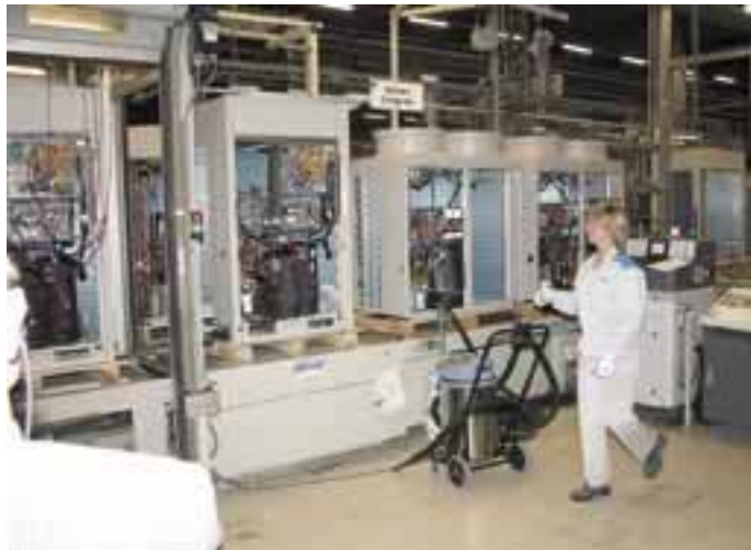
Daikin's VRV-Produktion in Oostende. Hier laufen Systeme der alten R 407C- und der neuen R 410A-Generation vom selben Band
