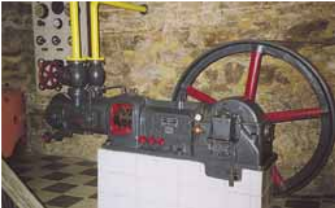
Linde-Verdichter der Maschinenfabrik Esslingen, Baujahr 1937, durch einen 35 PS-Dieselmotor der Gebr. Körting AG (Hannover) angetrieben
