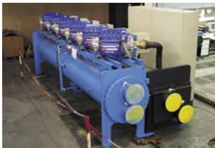
Bild 9 Kaltwassersatz QUANTUM 6 bei Werksabnahme, 1800 kW Kälteleistung
