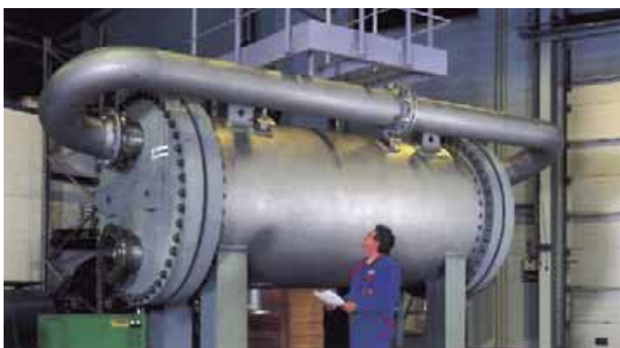
Der PSHE 14 hat einen Durchmesser von 1,4 m
