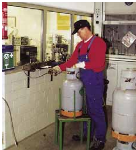
Anschließen einer Flasche für Abfall zur Verwertung (Farbe grau) zur Analyse auf Sortenreinheit
