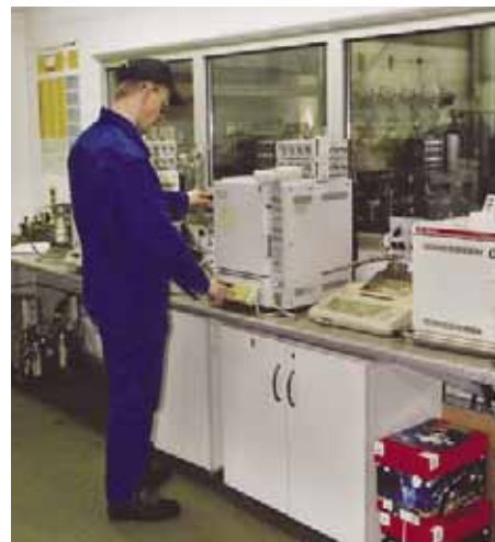
Gaschromatograph zur Analyse des Flascheninhalts
