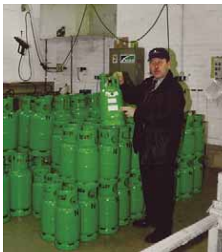
Franz-Josef Drieling zeigt es: Kältemittel-Neuware wird nur noch in Flaschen mit grüner Farbgebung ausgeliefert, ein Produktaufkleber definiert den Flascheninhalt
