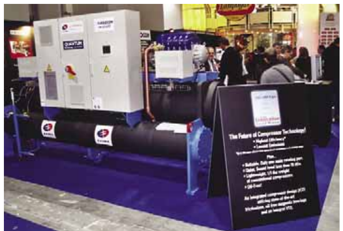
Natürlich war in Mailand auch die komplette Familie der Verdichter-Hersteller vertreten. Eine neue Anwendung präsentierte Axima Refrigeration als Unteraussteller mit einer kurzfristigen Aktion auf der Messe und dem Quantum-Verdichter, wobei es sich um einen ölfreien Turboverdichter handelt
