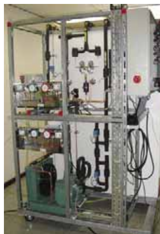
Maschinenrahmen mit Aggregaten, Ventilen, Reglern und Schaltschrank
