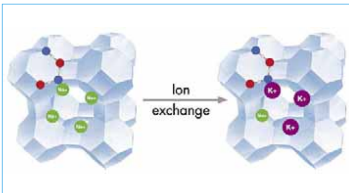
Bild 1 Kristallographische Einheitszelle der Zeo- lith vom Typ 4A und vom Typ 3A
