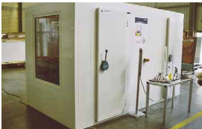
Was gibt es Neues bei Viessmann? Na, zum Beispiel dieses Entwicklungsprojekt „Brennstoffzellenanwendungen Kühlzelle“ im praktischen Betrieb
