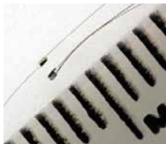
Kleinsensoren zur Temperaturmessung
