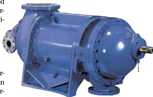
Seit 1977 im Programm ist die Kälteverdichterbaureihe Mark II mit Öleinspritzung und Volumenstromregelung für 7000 bis 10 000 m 3 /h
