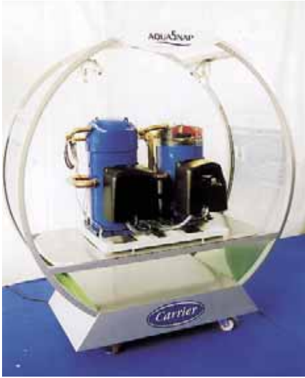
Das kältetechnische Herz bilden wie auch schon zuvor bei allen vorherigen AquaSnap-Flüssigkeitskühlern Scroll-Verdichter von Danfoss, jetzt mit dem Hochdruckkältemittel Puron® = R410A!
