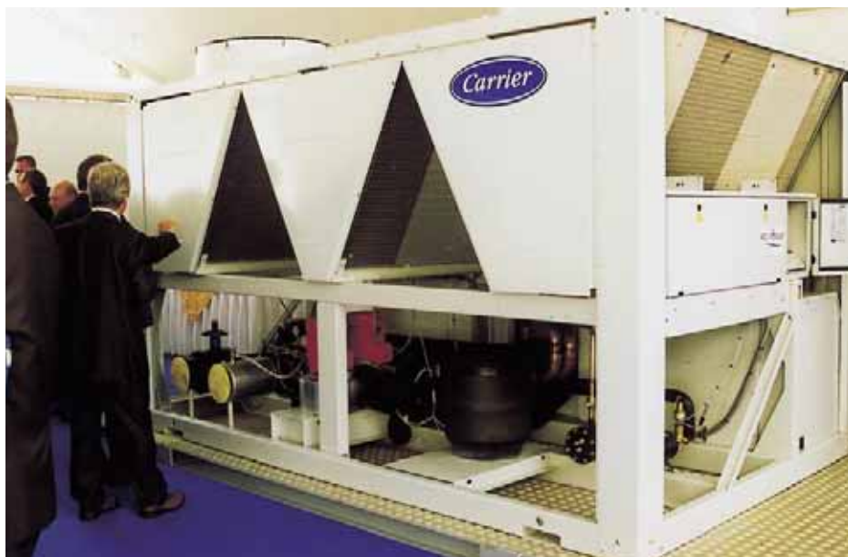
AquaSnap Puron®, der erste R410A-Flüssigkeitskühler der Welt für den kommerziellen Einsatz im Bereich von 193 bis 758 kW; erstmals für den europäischen Markt – wo Effizienz besonders gefragt ist – in 14 Leistungsstufen eingeführt
