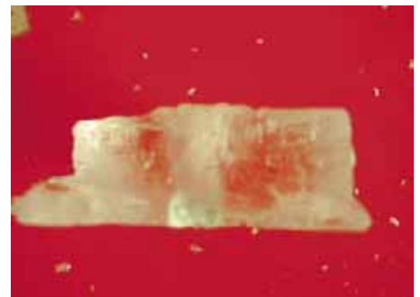
Bild 7 An beiden entnommenen Eisproben sind deutlich Lufteinschlüsse erkennbar
