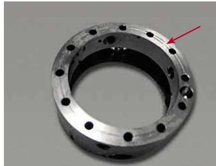
Bild 3b Muffenring der ausgebauten Gleitringdichtung
