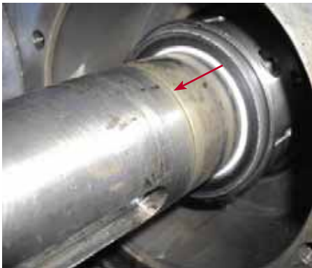
Bild 1 Die Gleitringdichtung ist mit dem Teflonring nur bis auf die verjüngte Antriebswelle aufgeschoben
