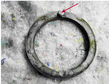
Bild 3a Mitnehmerring mit Zapfen der ausgebauten Gleitringdichtung
