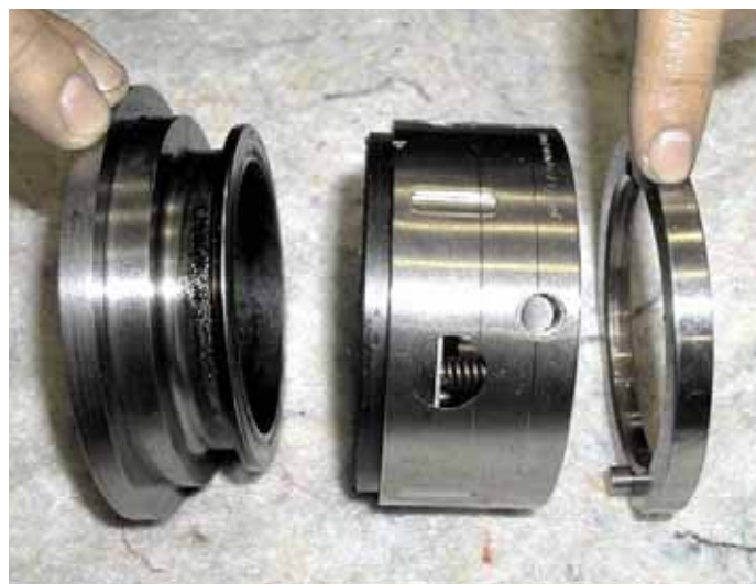
Bild 2 Die Gleitringdichtung und ihre einzelnen Bestandteile
