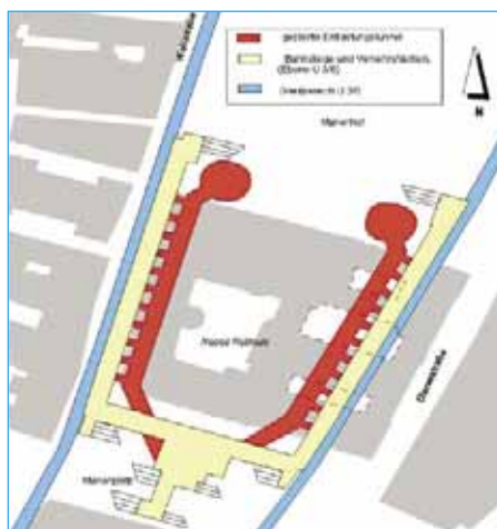
U-Bahnhof Marienplatz mit den beiden Erweiterungstunneln und Startschächten für die bergmännischen Vortriebe
