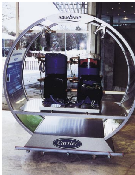
2 bis 4 Scrollverdichter je Kältemittelkreislauf passen sich mit dem Kältemittel R410A (Carrier-Bezeichnung PURON®) exakt der jeweiligen Kühllast an
