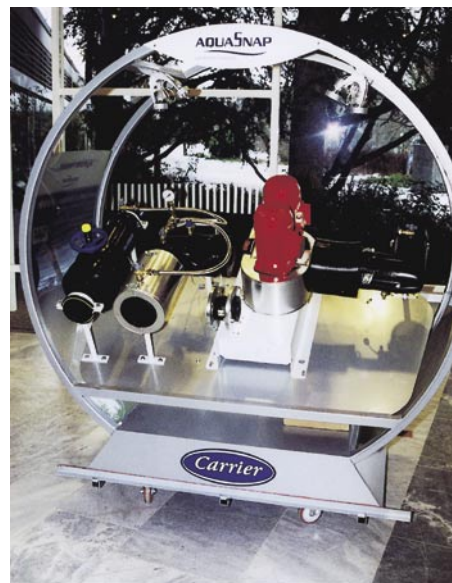
Umfassendes Hydraulikmodul, bestehend aus Hoch- oder Niederdruckwasserpumpe, Wasserfilter, Sicherheitsventil, Membran-Ausdehnungsgefäß, Wasserströmungswächter, Druckmesser mit Ventilen, Frostschutz und Strömungs-Regelventil; alles im Flüssigkeitskühler als eigene Baugruppe integriert
