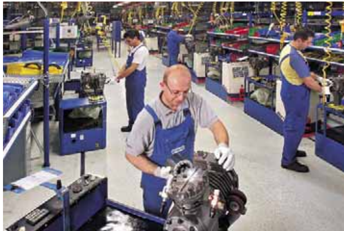
Verdichtertfertigung bei Copeland in Berlin. Die Aggregate „fahren“ auf speziellen Wagen entlang der Fertigungslinie auf am Boden aufgeklebten Induktionsschleifen
