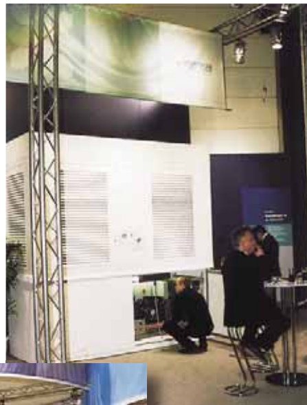
GTM/TEKO/WURM, auch auf der EuroShop ein starkes Team; TEKÖ zeigte erstmals einen Verbundkältesatz mit einer schalldämmenden Betonverkleidung – für die Außenaufstellung an einem Tiefkühlraum geeignet –, im oberen Gehäuse teil ist der luftgekühlte Verflüssiger untergebracht
