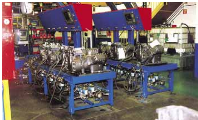
Überwachung des Trocknungsprozesses bei 4-, 6- und 8-Zylinder Semihmeretiks
