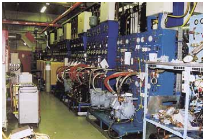
Dauerlaufprüfstände für Semihmeretiks und Scroll; hier auch einige Dual-Scrolls im Versuch
