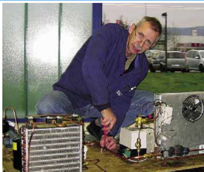
Springt vor Montagebegeisterung auf die Werkbank: Dieter befestigt die Saugleitung
