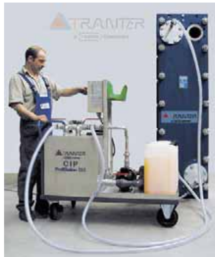
Reinigung eines Plattenwärmeeübertragers
