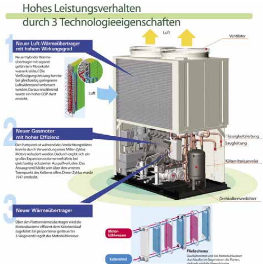
Drei Technologieeigenschaften zeichnen die Funktionweise der Sanyo ECO Gas-Wärmepumpe VRF-Multisystem besonders aus; sie werden hier dargestellt
