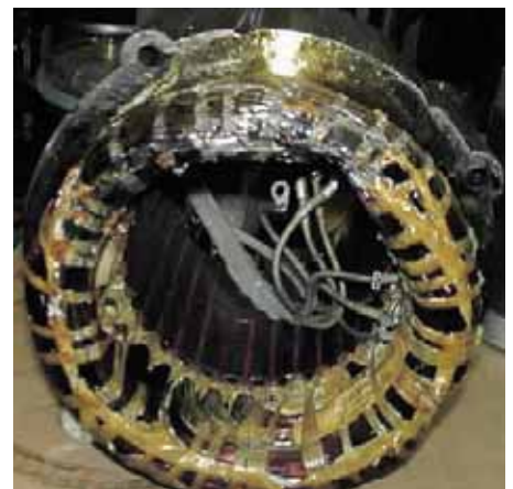
Bild 3 Durchgebrannter Wickelkopf eines Einbaumotors
