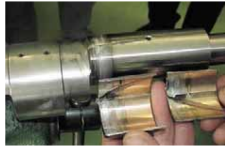
Bild 1 Ausgefallene Lager und Pleuellager eines Kältemittelverdichters
