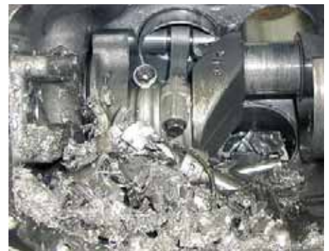
Bild 2 Zerstörtes Triebwerk und Pleuellagergehäuse eines Verdichters nach vorausgegangenem Lagerschaden
