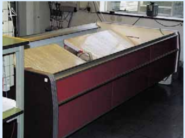
Adaptiver Enteisungstest an einer Tiefkühltruhe im Zentrallabor von Danfoss in Nordborg
