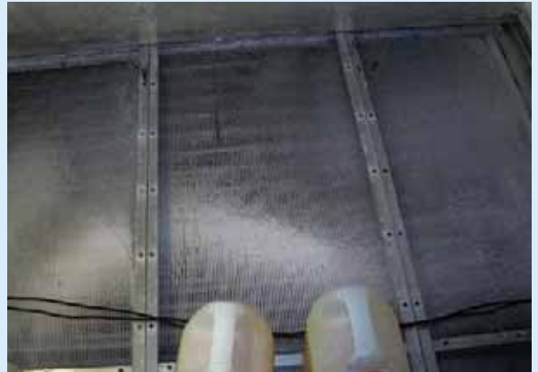
Adaptiver Enteisungstest am Verdampfer im Zentrallabor von Danfoss in Nordborg
