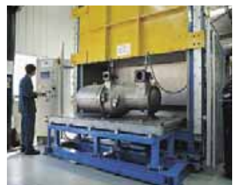
Eine der größten Investitionen wurde von Bitzer im Oktober 2004 mit der Einführung von Heliumdichtheitsprüfsystemen in der Verdichtermontage von Kompaktschrauben (compact screw compressors) und Aluminium-Fahrzeugverdichtern vorgenommen
