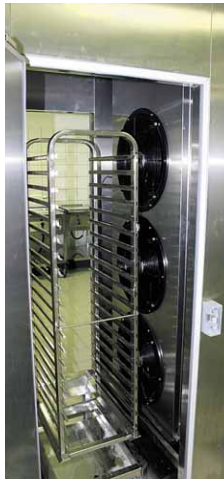
Beidseitige Anordnung von SGB-Verdampfern im Schnellabkühler: 37% Mehrleistung durch die Verwendung innenberippter Kupferrohre
