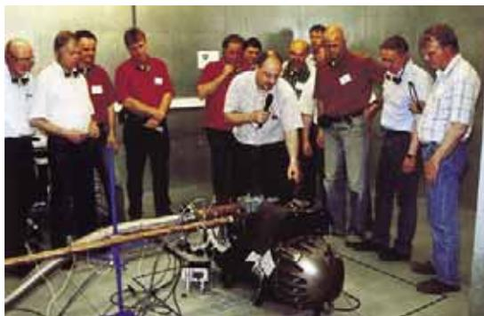
Der Dual-Scroll bei Geräuschpegelmessungen im Soundlabor, erläutert von Romain Pohlen, und dann auf einem Dauerlaufprüfstand. Dies war für die Berufsschullehrer zum Abschluss des Rundgangs durch die Copeland-Fertigung von besonderem Interesse
