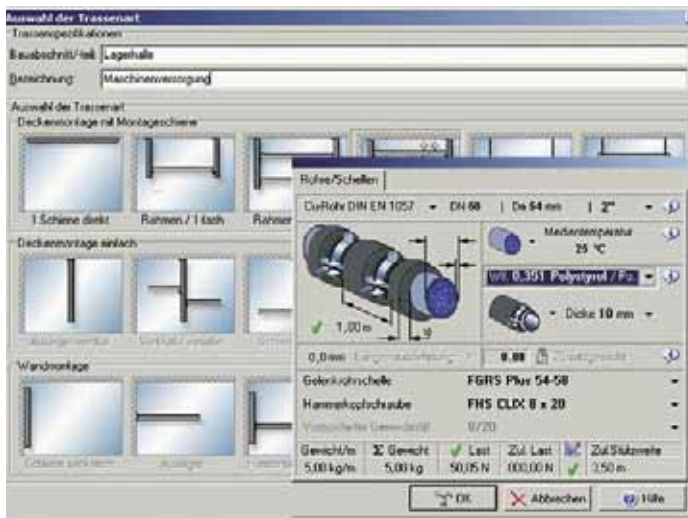
Die Berechnungssoftware unterstützt die Auslegung der Rohrleitungstrassen und der Befestigungselemente
