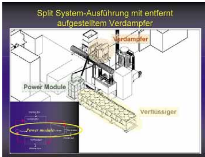
Bild 6 ORC-Split-System mit entfernt installiertem Verdampfer am Gasturbinenaustritt
