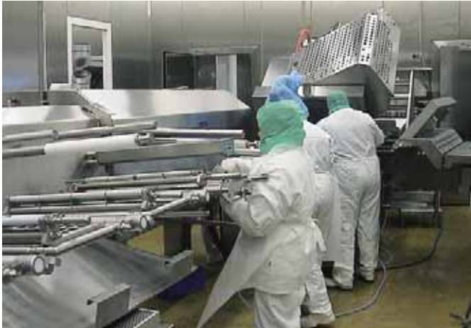
Bild 5 Bei einer relativ niedrigen Keimkonzentration kann die aufwendige Nassreinigung durch eine Trockenreinigung (Bild) ersetzt werden, was Maschinenstillstände deutlich verkürzt
