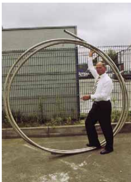
Von der Rolle: Flexibles Edelstahlrohr, hier Kälteanlagenbauermeister Christian Scholz mit einem Rhönradauglichen Resteverschnitt, dient in einer Länge von 100 m als Erdwärmerohr dem CO 2 als Transportfluid; auf dem rechten Bild fertig installiert mit isoliertem Wärmeaustauscher und AKV
