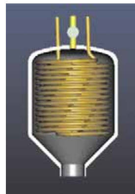
Wärmeaustauscher aus Cu-Rohr. Links im Bild das in seiner Länge von 100 m in seiner Darstellung verkleinerte CO 2 -Erdwärmerohr
