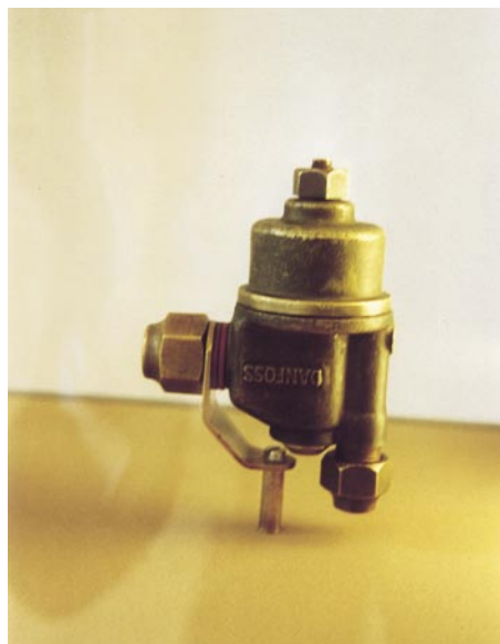
Mads' Patent: Die Ersterfindung eines „dänischen“ Expansionsventils war eigentlich die druckgesteuerte Version, das ARV; abgedrückt wurde mittels Hand/Fußluftpumpe in Mutters Zinkwanne im Wasserbad, um die Ventildichtungen zu prüfen
