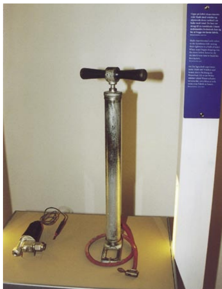
Mads' Patent: Die Ersterfindung eines „dänischen“ Expansionsventils war eigentlich die druckgesteuerte Version, das ARV; abgedrückt wurde mittels Hand/Fußluftpumpe in Mutters Zinkwanne im Wasserbad, um die Ventildichtungen zu prüfen
