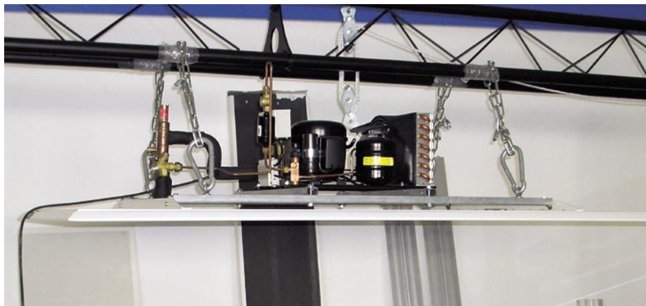
Bild 1 Erster Prototyp einer direktverdampfenden Kühldecke
