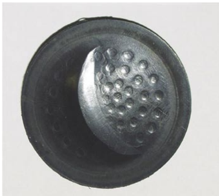
Ergebnis der Dekompression eines Elastomers (FPM WS 12.907)
