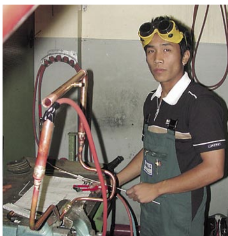
Anoucha Kertsai bei seiner Arbeitsprobe mit Kupferrohr: Präzisionsarbeit beim Biegen und Löten; die Toleranz bei der Maßgenauigkeit durfte 2,5 mm nicht unterschreiten
