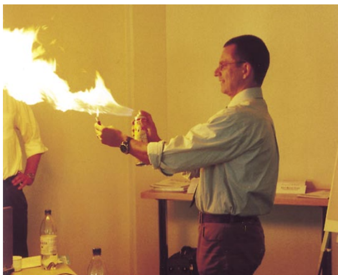
Vilim Mergls Brennbarkeitstest mit Spraydose und Feuerzeug in kurzer Entfernung. Ab 1 m Abstand ist die Entflammbarkeitsgrenze schon unterschritten
