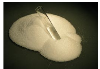
Flüssige Salze, in der Fachsprache ionische Flüssigkeiten genannt, sollen vor allem in der Gebäudeklimatisierung ökologische und wirtschaftliche Vorteile mit sich bringen
