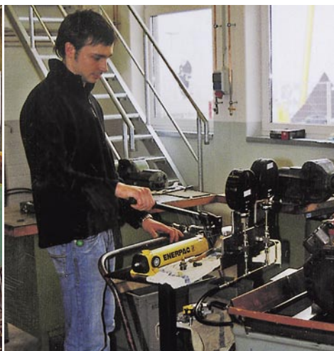
Einige Versuchsanordnungen im neuen Entwicklungszentrum für Hubkolbenverdichter in Schkeuditz; das rechte Bild zeigt die Vorbereitung einer Versuchsanordnung mit einem CO 2 -Verdichter
