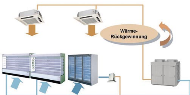
Bild 1 Der schematische Systemaufbau eines Conveni-Pack Systems
