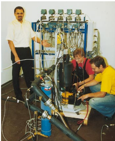
Im neuen Kalorimeter mit schallabsorbierender Auskleidung wird gerade der Prototyp einer Brauchwasserwärmepumpe mit CO 2 als Kältemittel vermessen (v. l.): Ing. Heinrich Huber und DI Andreas Presetschnik von arsenal research sowie Ing. Hannes Leister vom Hersteller Heliotherm Wärmepumpentechnik in Langkampfen/Tirol
