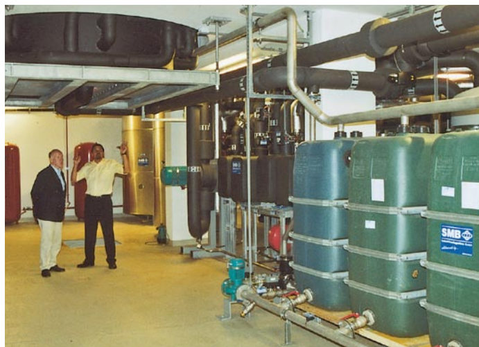
Wärmepumpen-Testzentrum von arsenal research, oben und unten. Hier ein Blick auf den speziell konstruierten Solebehälter, der zur Simulation von verschiedenen Erdreichtemperaturen bei der Prüfung von Wärmepumpen mit Direktverdampfung dient
