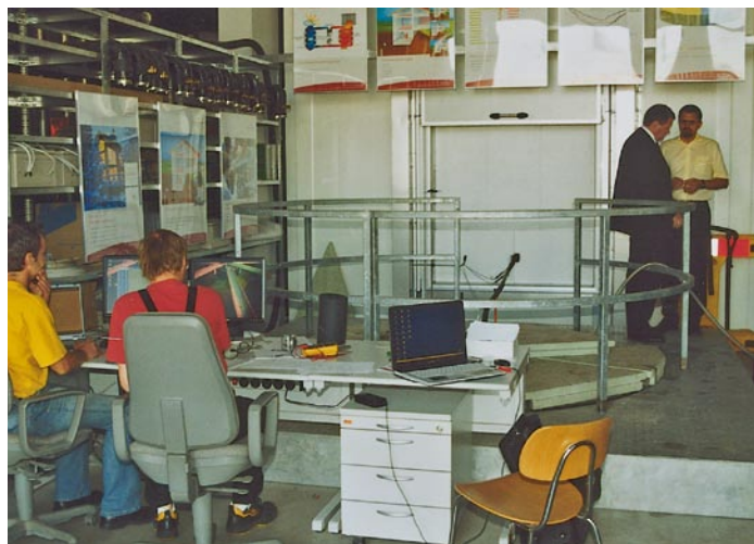
Wärmepumpen-Testzentrum von arsenal research, oben und unten. Hier ein Blick auf den speziell konstruierten Solebehälter, der zur Simulation von verschiedenen Erdreichtemperaturen bei der Prüfung von Wärmepumpen mit Direktverdampfung dient
