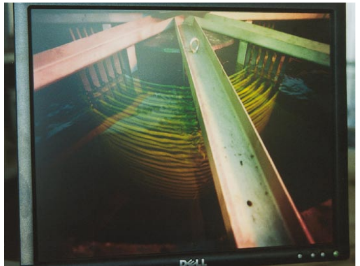
Auf dem Bildschirm des PCs: Simulationskreislauf einer Brauchwasser-Wärmepumpe mit CO 2 als Kältemittel; auf dem rechten Bild sind die Verdampferrohrschlangen im Solebehälter zu sehen, mit dem unterschiedliche Erdreichtemperaturen simuliert werden können
