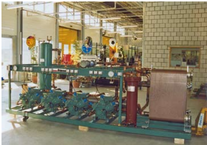
Eine wachsende Spezialität bei der friosol in Egerkingen: Verbundanlagenbau mit Bitzer Verdichtern in den unterschiedlichsten Konfigurationen. 7 subkritische Kaskadensysteme wurden in der Schweiz seit 2005 ausgeliefert
