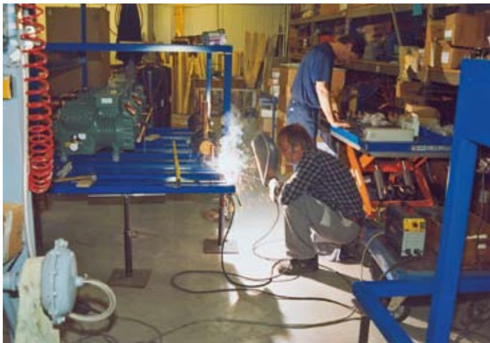
Eine wachsende Spezialität bei der friosol in Egerkingen: Verbundanlagenbau mit Bitzer Verdichtern in den unterschiedlichsten Konfigurationen. 7 subkritische Kaskadensysteme wurden in der Schweiz seit 2005 ausgeliefert
