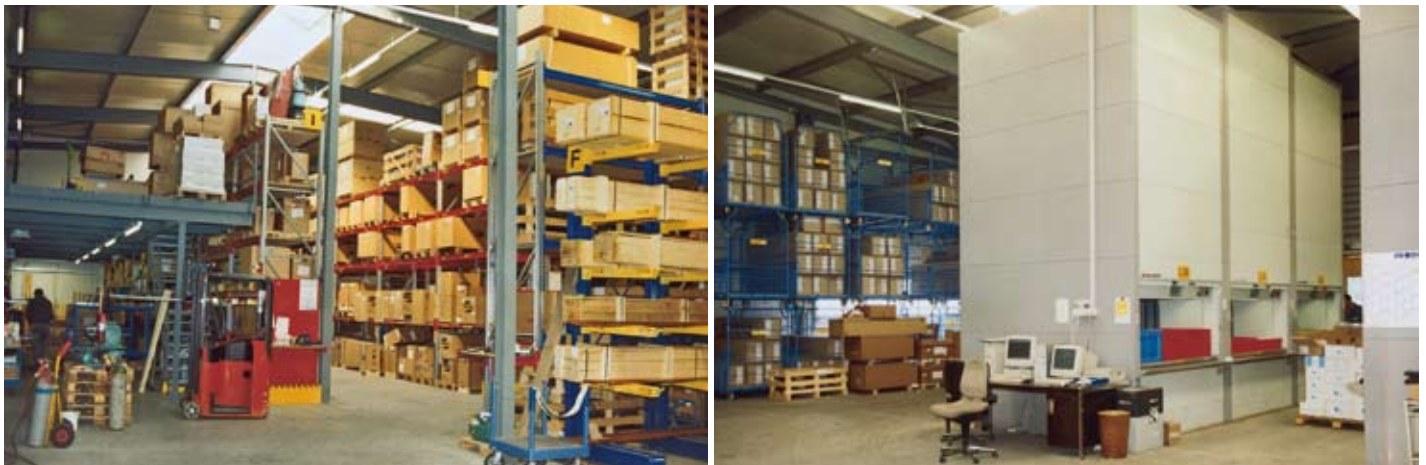
Großräumige Lagerhaltung im Logistik- und Distributionscenter mit ca. 2500 m 2 Fläche. Kleinkomponenten-Bevorratung über Kardex-Lifte mit Schäfer-Lagerungssystem
