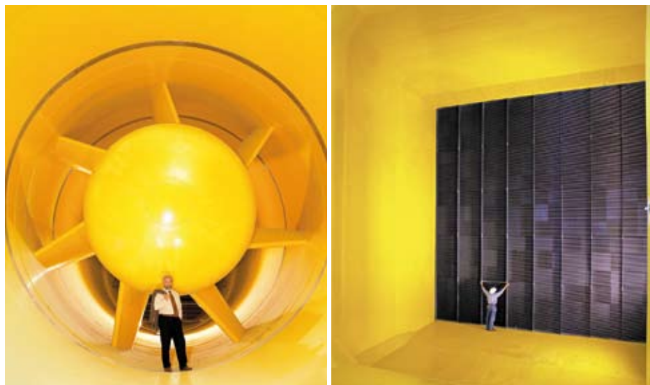
Größenverhältnisse und Dimensionen: Gewaltige Luftleistung erzeugt dieser Ventilator, eine enorme Kälteleistung die lamellierten Wärmetauscher in Modulbauweise von Güntner
